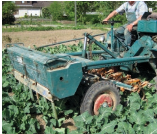
Bild 2 (li.) Teilautomatisierte Bodenprobenahme in einem Begrünungsbestand
