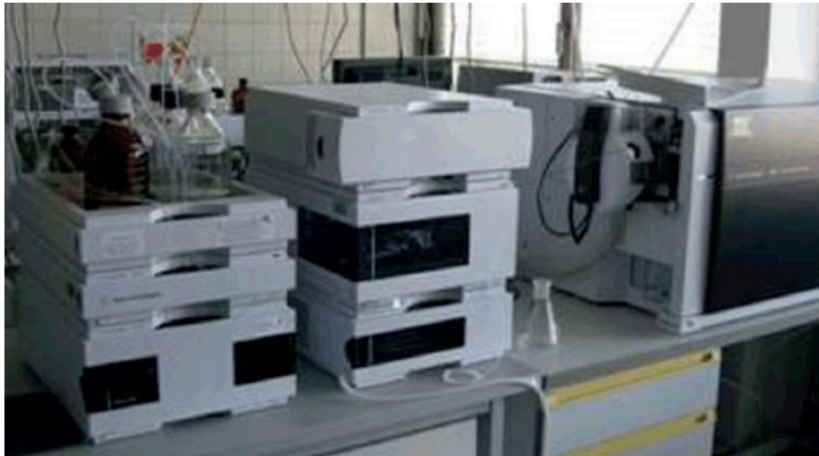
LC-MS-MS-Messgerät zur Bestimmung von PFC. Bild: A. Trenkle
