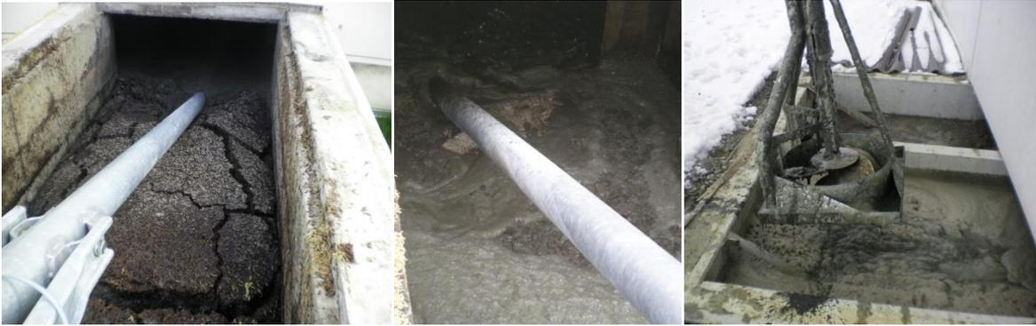
**Bilder links: Mobile Rührwerke zum Homogenisieren von Gülle sowie unterschiedlich dicke Schwimmschichten auf der Gülle**
