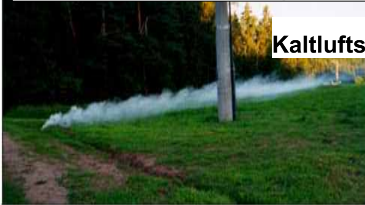
Abbildung 1: Rauchpatronenversuch, Blick den Hang hinab
